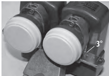
Bild 5: Beispiel für eine Multifeedanordnung
