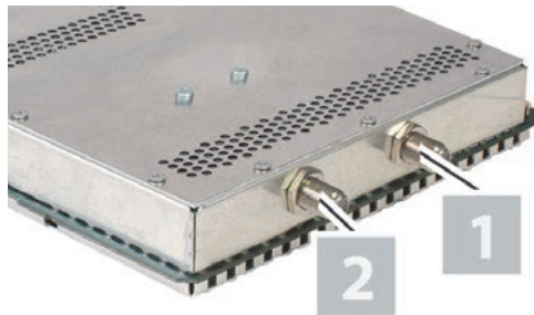
Bild 5: Tuner mit SAT-ZF verkabeln
